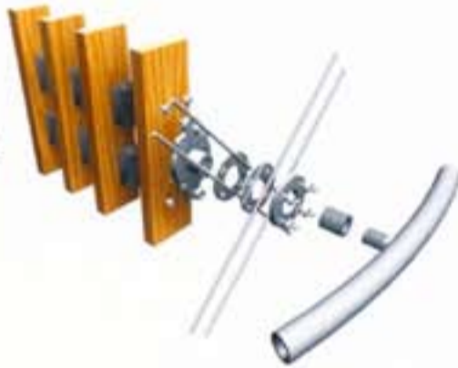
Verbindung der Holzlamellen mittels Gussteilen zu einer schubsteifen Koppelung
