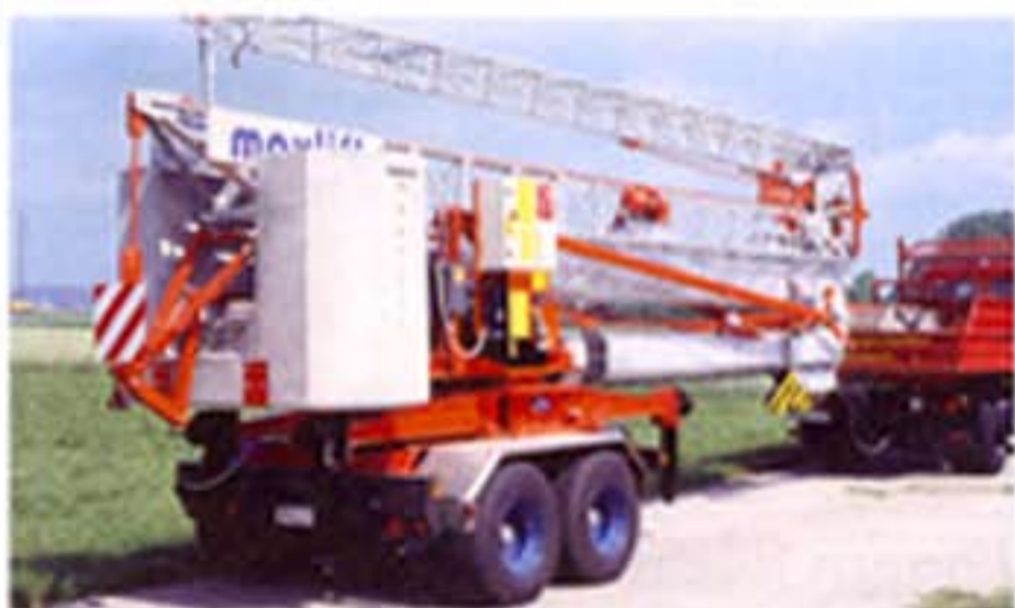
Nur 15 min dauert der Auf- und Abbau des Maxlift 102
