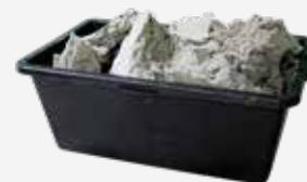
Mit Hilfe einer Bohrmaschine und einem Farbrührer wird der Dämmstoff zu einer losen flockigen Schüttung aufgelockert. Der Dämmstoff wird danach in die Konstruktion geschüttet und mittels Rechen lückenlos in der Konstruktion verteilt.
