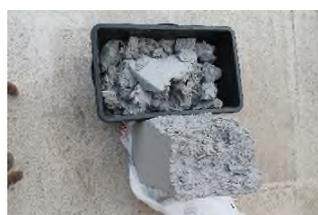
Der verpresste Dämmstoff wird in grobe Stücke zerkleinert und in die Wanne gegeben.
