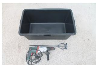
Zur Verarbeitung des Dämmstoffes wird eine Wanne, eine Bohrmaschine sowie ein Farbrührer benötigt.
